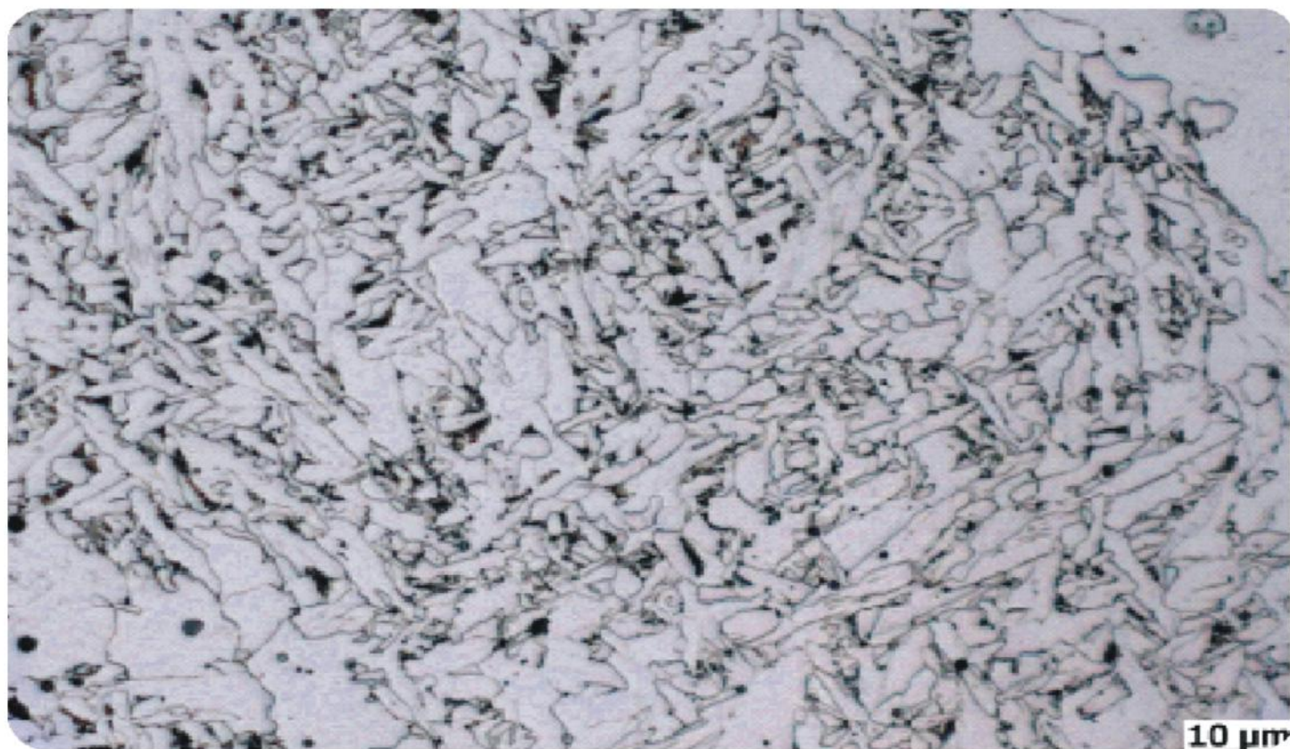
▲ 焊缝组织微观金相图
